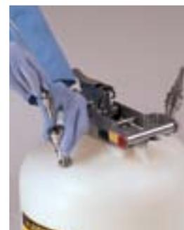
Tube de 3/8" pour un débit continu des liquides d'une source extérieure à l'intérieur du bidon qui peut facilement être débranché avec un raccord à valve spécial sans émission de vapeurs ou de fuite de solvant.
