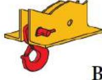
**C:** Des crochets supplémentaires permettent autant de points d'ancrage
