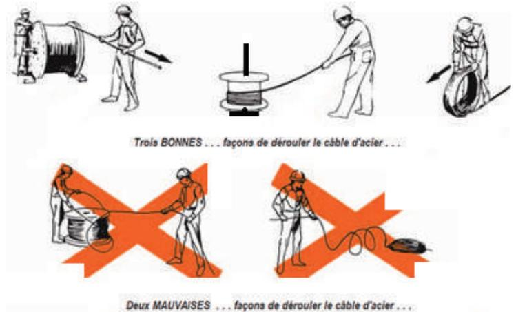
Un grand soin doit être apporté à ces deux opérations, que ce soit à partir de bobines ou de rouleaux. Sortir le câble de la bobine par-dessus les rebords (flanges)... ou tirer le câble d'un rouleau alors
