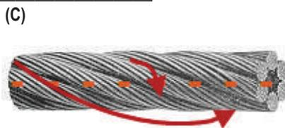
"LANG" ... est le type dont la direction des fils dans le torons est la même que la direction des torons du câble. Le toronnage... ou la direction des torons s'observe aussi par rapport à l'axe du câble, dans le sens des aiguilles de l'horloge, ou l'inverse!
