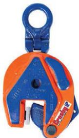
La pince de levage vertical IPU10 s'utilise pour lever, faire pivoter, déplacer ou transférer verticalement des tôles, des plaques ou des objets manufacturés de la position horizontale en position verticale et à nouveau en position horizontale (180°) en fonction des besoins. L'œil articulé permet de placer et de lever la charge dans n'importe quelle direction ou avec une élingue à plusieurs brins sans levage latéral de la charge.
