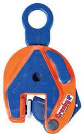
La pince de levage vertical IP10 s'utilise pour lever, faire pivoter, déplacer ou transférer verticalement des tôles, des plaques ou des objets manufacturés de la position horizontale en position verticale et à nouveau en position horizontale (180°) en fonction des besoins. Généralement utilisée comme point d'attache unique ou, avec un écarteur, avec plusieurs câbles de saisie verticaux.
