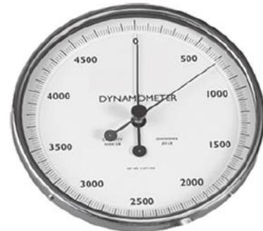
Le modèle "Junior" dispense une détection de pointe aussi bien que la lecture de charge suspendues. La configuration de l'élément de charge ainsi que les lecteurs de tensions choisis pour le "Junior" lui permettent une performance maximale avec tolérance de 0.2%, niveau de précision offrant des possibilités d'utilisation dans une vaste étendue d'application. La lecture d'informations se fait selon une résolution de '1 partie par 1000', facilitant la prise de données lors de levages critiques !
